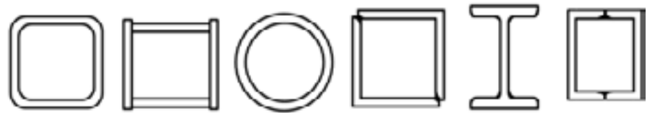
Figura 3. Sección transversal de contravientos
