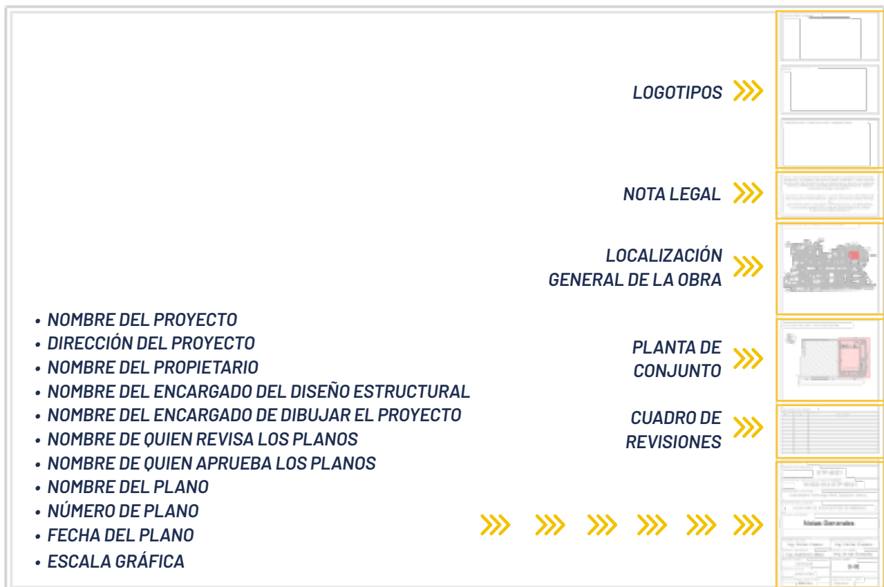
Fig. 04. Solapa de planos estructurales
