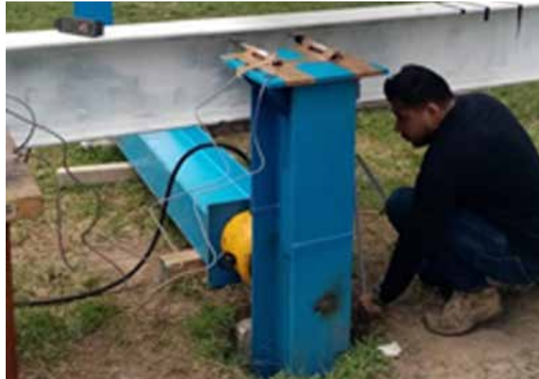
Figura 10. Ejecución de prueba ante carga lateral.
