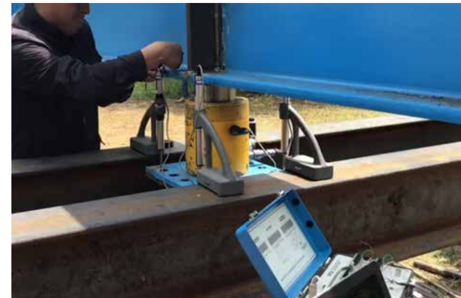
Figura 6 Ejecución de prueba de carga a compresión axial.
