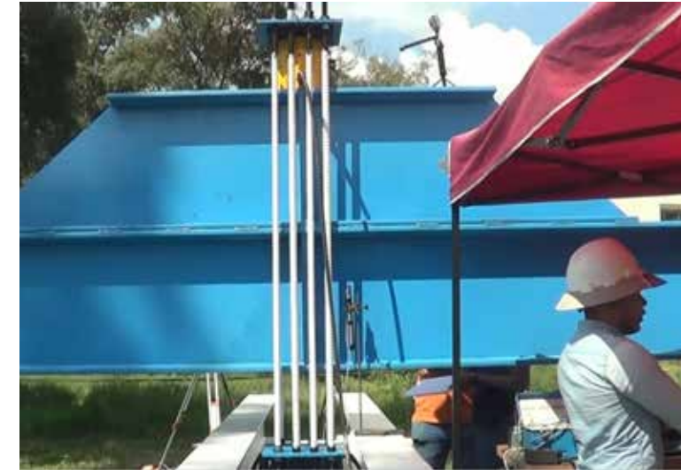
Figura 8. Ejecución de prueba de carga a tensión axial.
